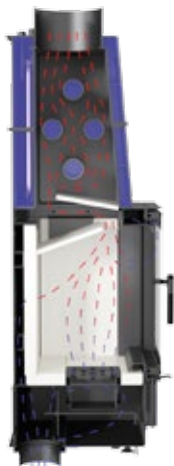
Obrázek 4. Schéma oběhu vzduchu uvnitř vložek z řady LUCY PW.
