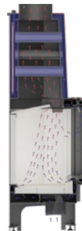
Obrázek 10. Schéma oběhu vzduchu uvnitř vložek z řady NADIA PW.
