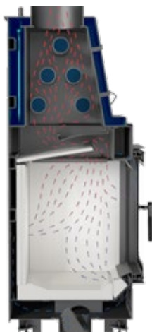
Obrázek 16. Schéma oběhu vzduchu uvnitř vložek z řady MB PW.
